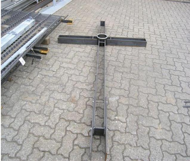
Das Kreuz wurde hergestellt von dem Stockstädter Kunstschmied Michael Kempf und hat eine Höhe von 250 cm, der Querbalken ist 175 cm breit. Das Kreuz hat ein Gesamtgewicht von 90 kg und besteht aus verzinktem Bandstahl in sandgrauer Farbe mit leichtem Silbereffekt. Das Fundament besteht aus zwei Quereisen und hat eine Tiefe im Stein von 40 cm. Die Kosten in Höhe von 1280 Euro wurden von dem Unternehmer Horst Fleischer aus Kleinostheim übernommen.
